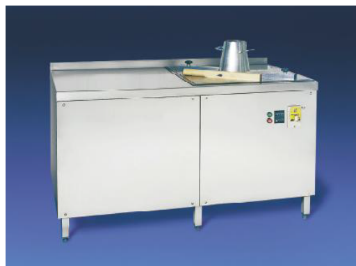
Stół roboczy z wbudowanym stolikiem rozpływowym
