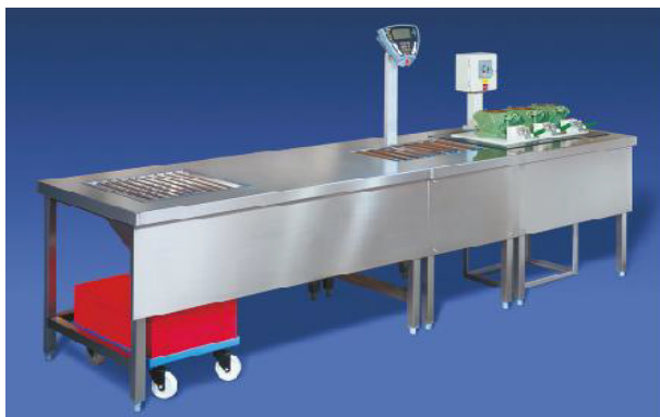
Stół roboczy zabudowany wagą, stołem wibracyjnym oraz miejscem do zrzutu betonu
