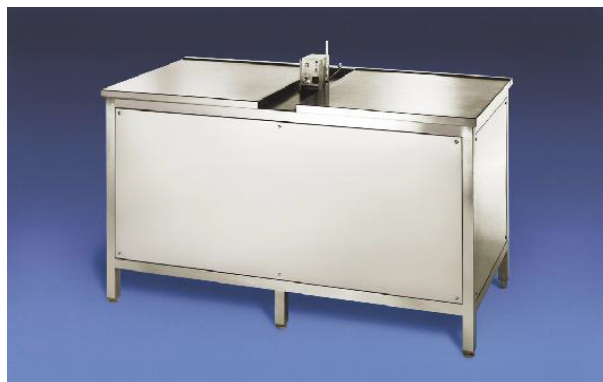
Zabudowana wanna z termostatem do przechowywania próbek
