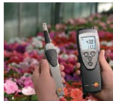
Sonda wilgotności dołączona do uchwyty radiowego np. do monitorowania regulacji klimatyzacji
