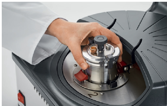
FRITSCH SelfLOCK: Misy mielące są wkładane i zatrzaskują się bezpiecznie przy niewielkim nacisku. Zamknięcie komory mielenia i mielenie również rozpoczyna się automatycznie.
