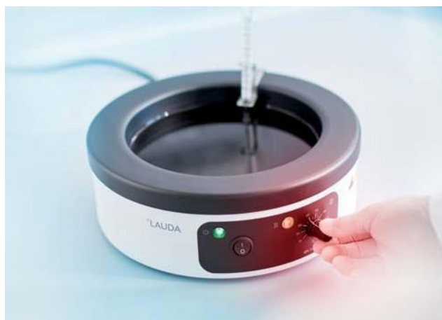
Okrągła wanna o średnicy 200 mm i głębokości użytkowej 50 mm
