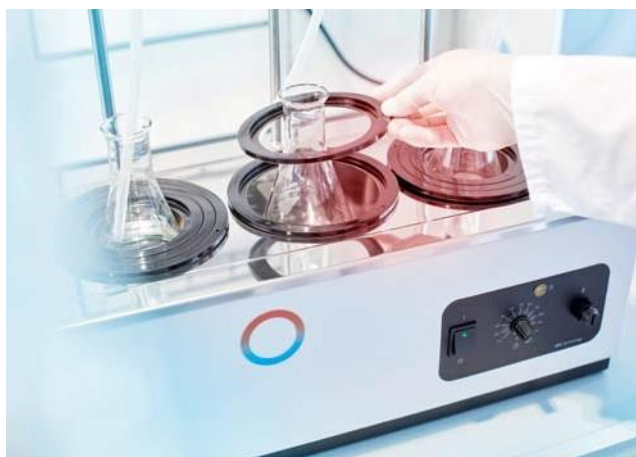
Perforowane osłony składają się z wieloczęściowego zestawu pierścieni. Poszczególne pierścienie można zdejmować
