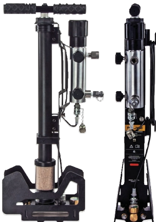
Model 700HPPK jest wyposażony w składane nóżki, które ułatwiają jego pakowanie.
