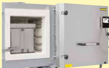
Równolegle przesuwane drzwi, otwierane w stanie nagrzania
