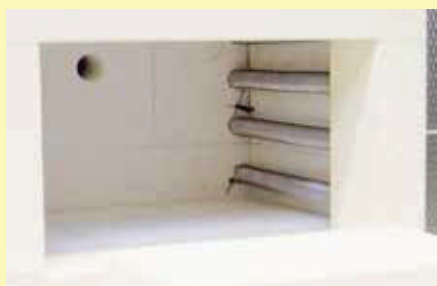
Komora pieca z izolacją z cegły ogniotrwałej o wysokiej jakości
