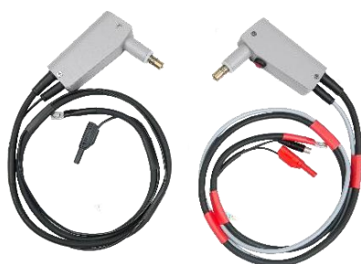
Kable prądowe i kable pomiarowe z sondami Kelvina
