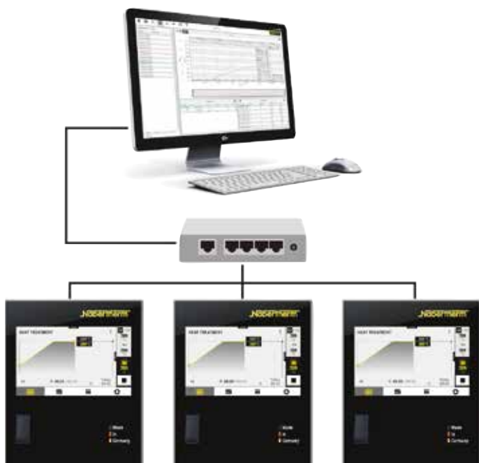
Przykładowa konstrukcja z 3 piecami
