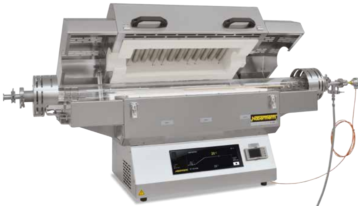
Piec rurowy RSH 80/500/13 z gazoszczelną rurą roboczą ze szkła kwarcowego i chłodzonymi powietrzem kołnierzami próżniowymi (pakiet gazowy 15)
