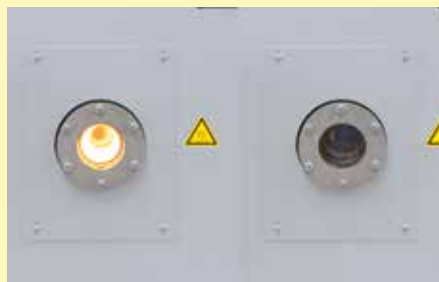
Chłodzony wziernik ze szkła szafirowego (po lewej w temperaturze roboczej, po prawej w temperaturze pokojowej)
