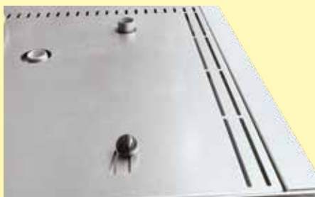
Zamykany króciec powietrza odlotowego umieszczony w pokrywie pieca
