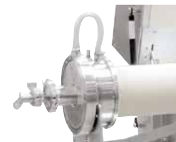
Kołnierz próżniowy chłodzony wodą (pakiet zasilania gazem 2)
