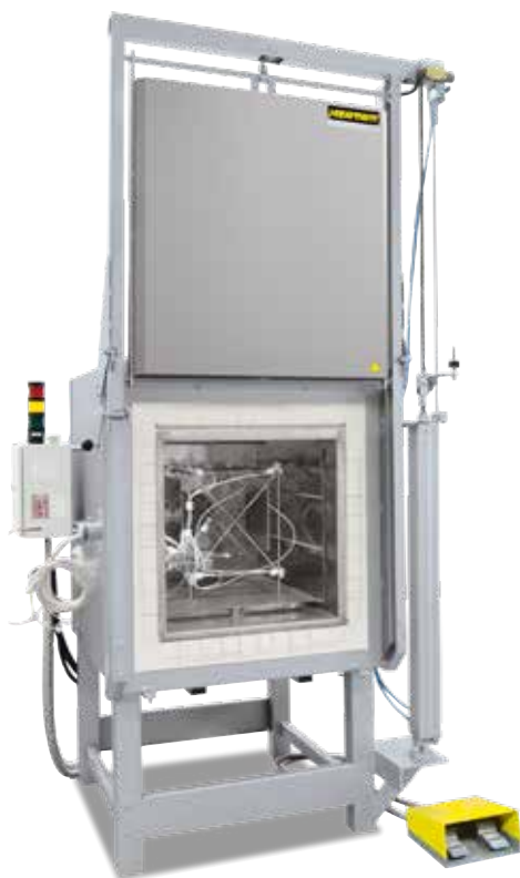
Stojak pomiarowy do wyznaczenia równomierności temperatury
