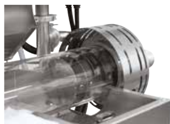
Kołnierz z zabezpieczeniem przed strumieniem (pakiet zasilania gazem 15)
