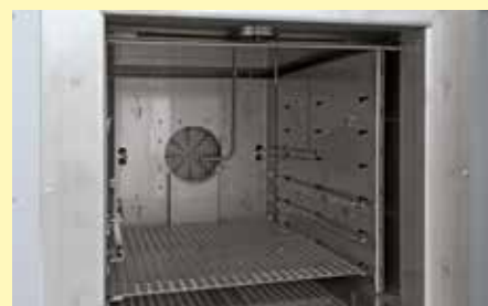
Komora wewnętrzna z płytą wkładaną, termoelementami i monitorowaniem ciśnienia
