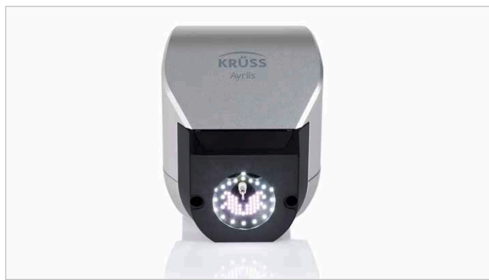
Zaawansowana technologia w niewielkiej przestrzeni: 90 diod LED generuje wzory odbić dla trójwymiarowej rekonstrukcji kropli
