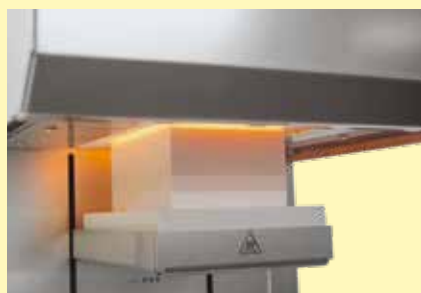
Automatyczne opuszczanie stołu do szybkiego chłodzenia
