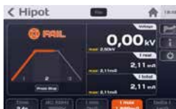
Test zakończony niepowodzeniem
