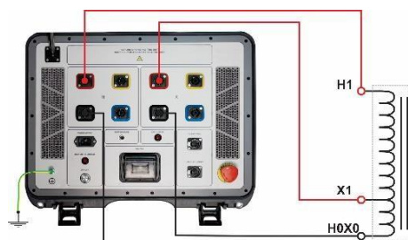
Podłączanie TWR-B do autotransformatora jednofazowego
