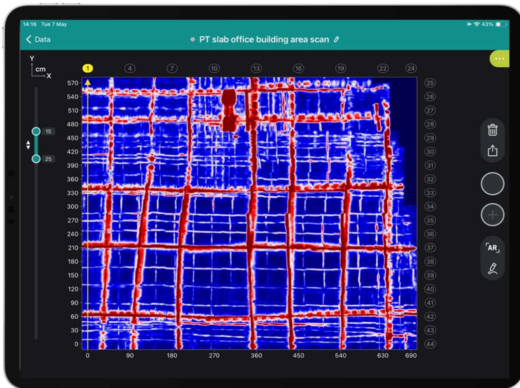
Rysunek 55: Aplikacja GP do skanowania obszaru płyty betonowej PT
