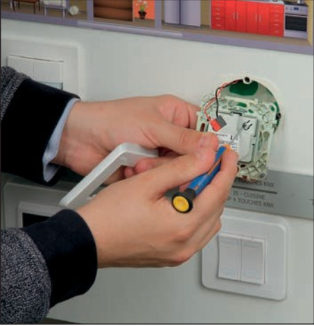
Zestaw przełączników typu domowego oraz KNX jest zintegrowany z panelem przednim. Przezroczysta płytka na uniwersalnym adapterze zakrywa złącza i chroni styki elektryczne; dostępne pozostają jedynie przyciski programujące. Przyciski można bardzo łatwo zdjąć, co ułatwia dostęp w celu programowania.
