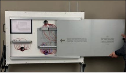
Elementy są podłączone na tylnym panelu za pomocą zacisków przemysłowych, co zapobiega zużyciu zacisków komponentów.
