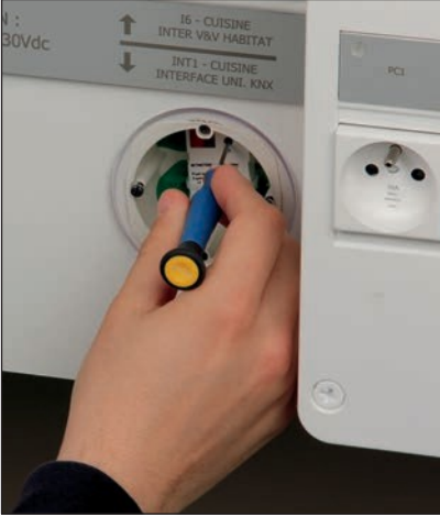
Zestaw przełączników typu domowego oraz KNX jest zintegrowany z panelem przednim. Przezroczysta płytka na uniwersalnym adapterze zakrywa złącza i chroni styki elektryczne; dostępne pozostają jedynie przyciski programujące. Przyciski można bardzo łatwo zdjąć, co ułatwia dostęp w celu programowania.
