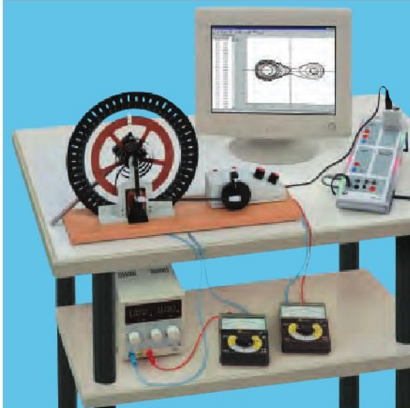
Drgania wymuszone harmoniczne oraz bezładne obrotowe – Rejestracja przy pomocy CASSY (P1.5.3.4)
