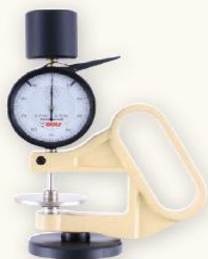
DMH 3-L specjalny do skór ze znormalizowanym naciskiem 50 kPa
