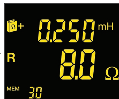
Ekran 3: Wartość części rezystywnej i indukcyjnej zmierzonej impedancji
