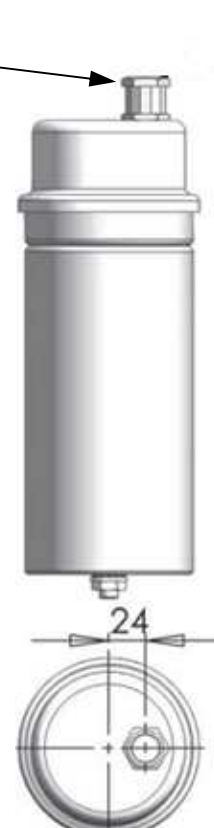
Obudowa 2 z kapturkiem ochronnym IP54
