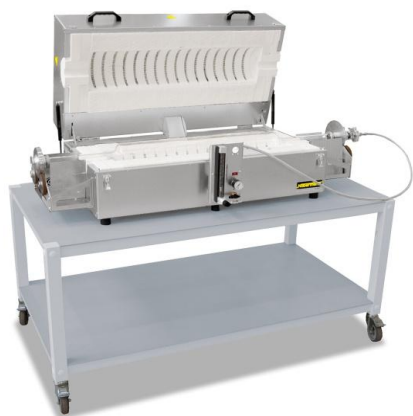
Piec obrotowy rurowy RSRB 120/750/11 jako model stołowy do pracy okresowej
