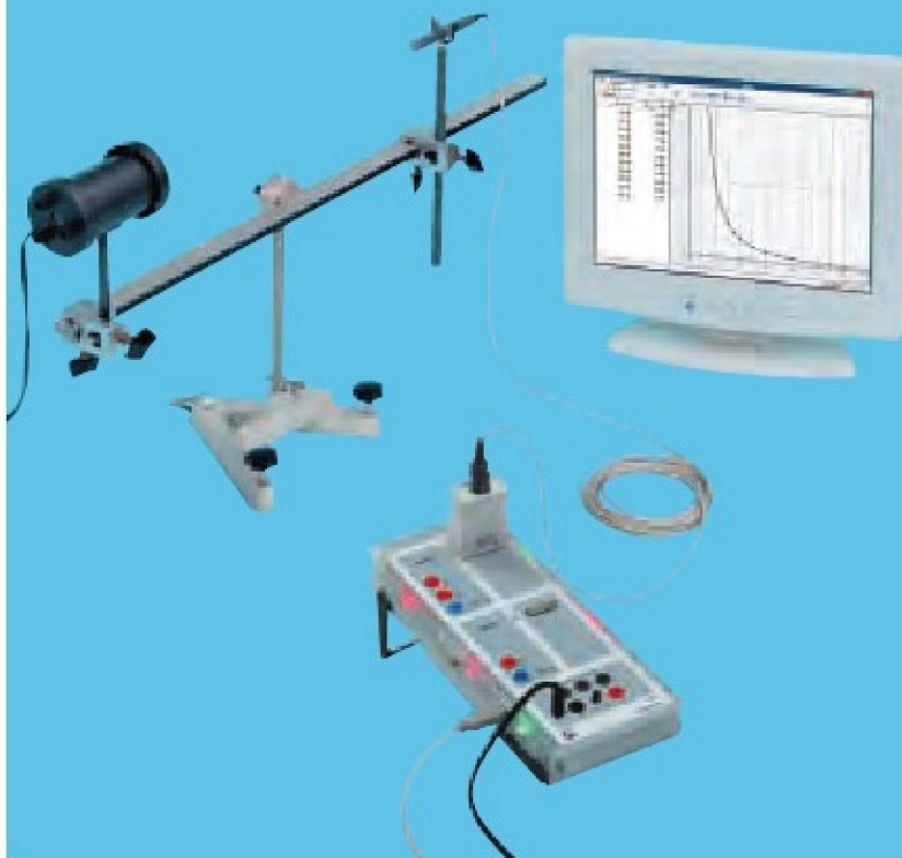
Określanie natężenia światła w funkcji odległości od źródła. Rejestracja i analiza za pomocą CASSY (P5.5.1.2_a)
