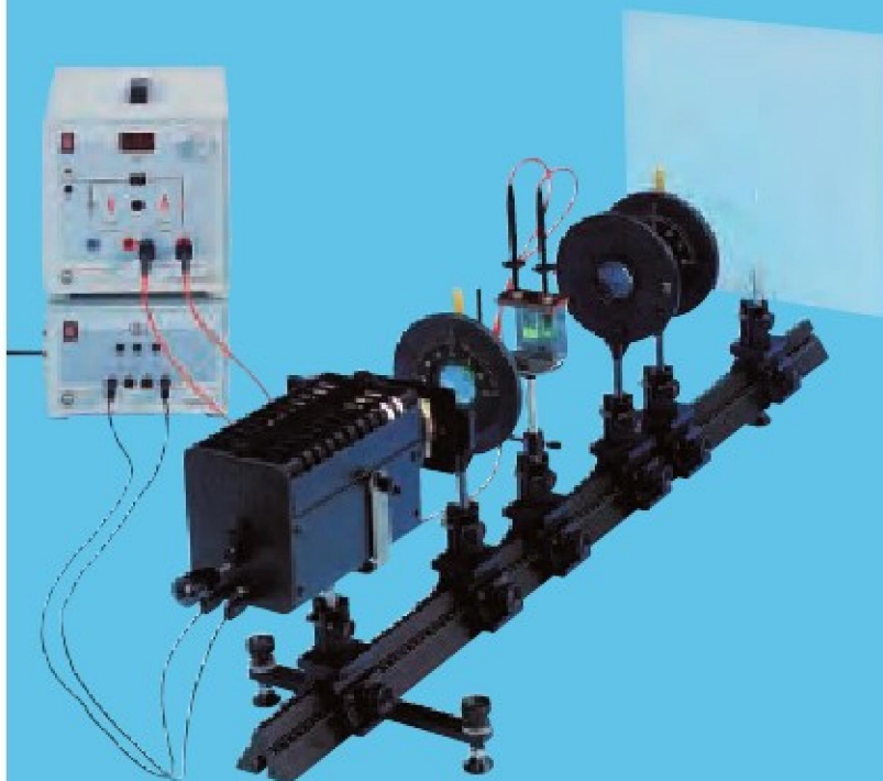
Badanie zjawiska Kerra w nitrobenzenie (P5.4.4.1)
