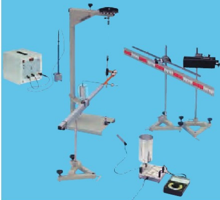
Potwierdzenie prawa Coulomba. Pomiar za pomocą wagi skrętnej, zaprojektowanej przez Schürholza (P3.1.2.1)
