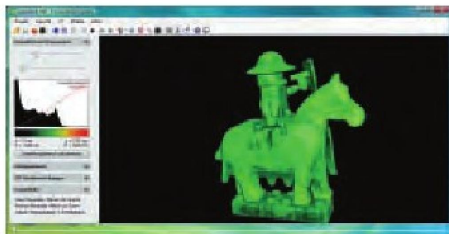
Tomografia komputerowa elementu zestawu Lego (P6.3.8.2)
