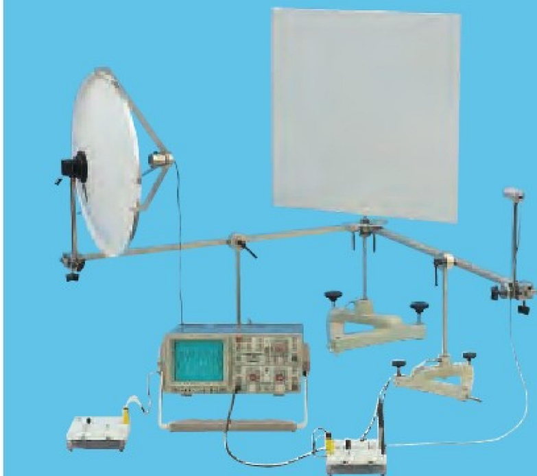
Odbicie płaskich fal ultradźwiękowych na płaskiej powierzchni (P1.7.4.1)
