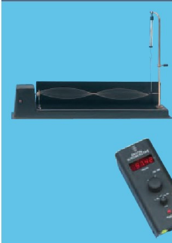
Określenie prędkości fazowej spolaryzowanych fal w eksperymencie według Melde (P1.6.3.2)
