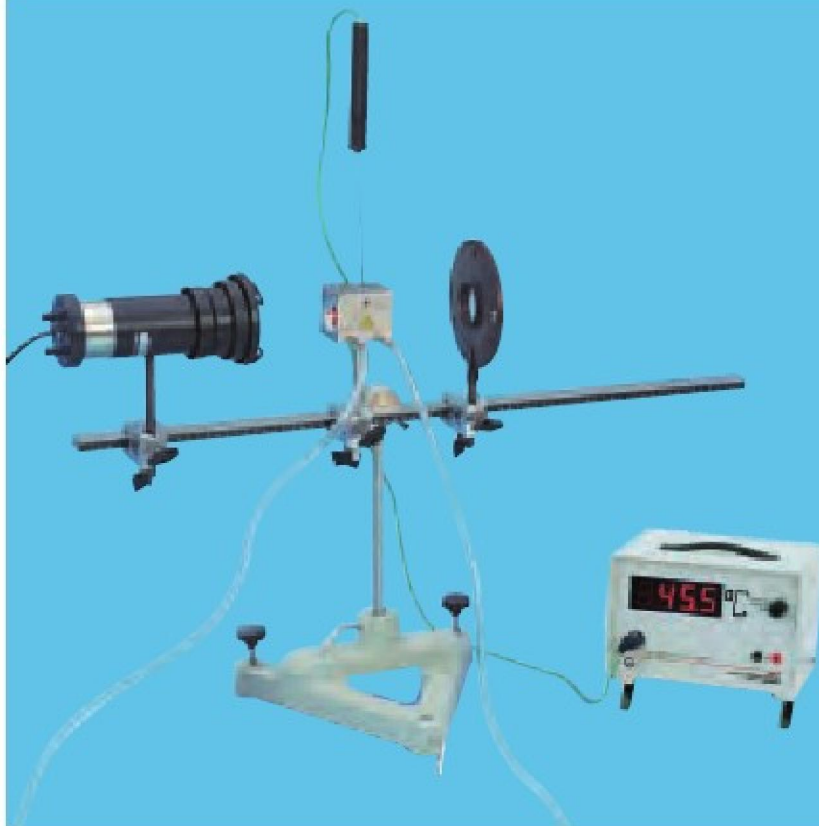
Obserwowanie przejścia fazowego pomiędzy fazą ciekłą i gazową w punkcie krytycznym (P2.4.3.1_b)
