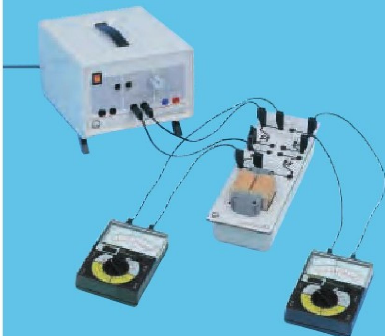
Przekształcanie napięcia i natężenia za pomocą transformatora (P3.4.5.1)
