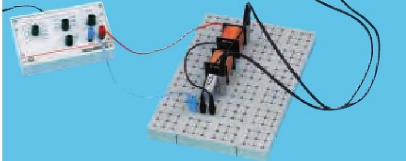
Pomiar prądu w cewce podczas gdy jest włączony i wyłączony i wyłączony prąd stały (P3.6.2.1)
