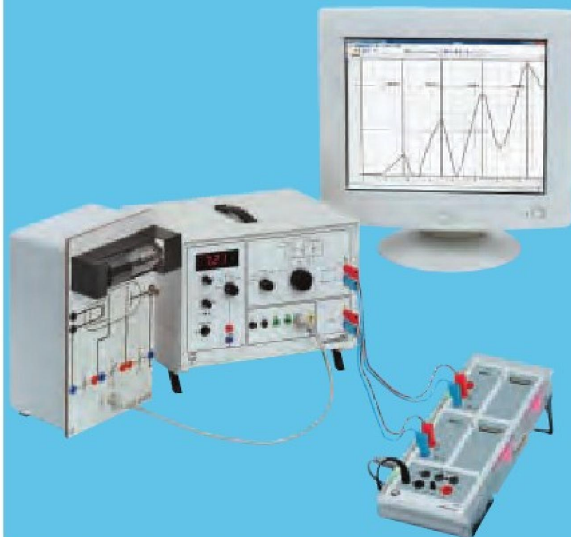
Doświadczenie Francka-Hertza z neonem - Rejestracja oraz analiza za pomocą CASSY (P6.2.4.4)
