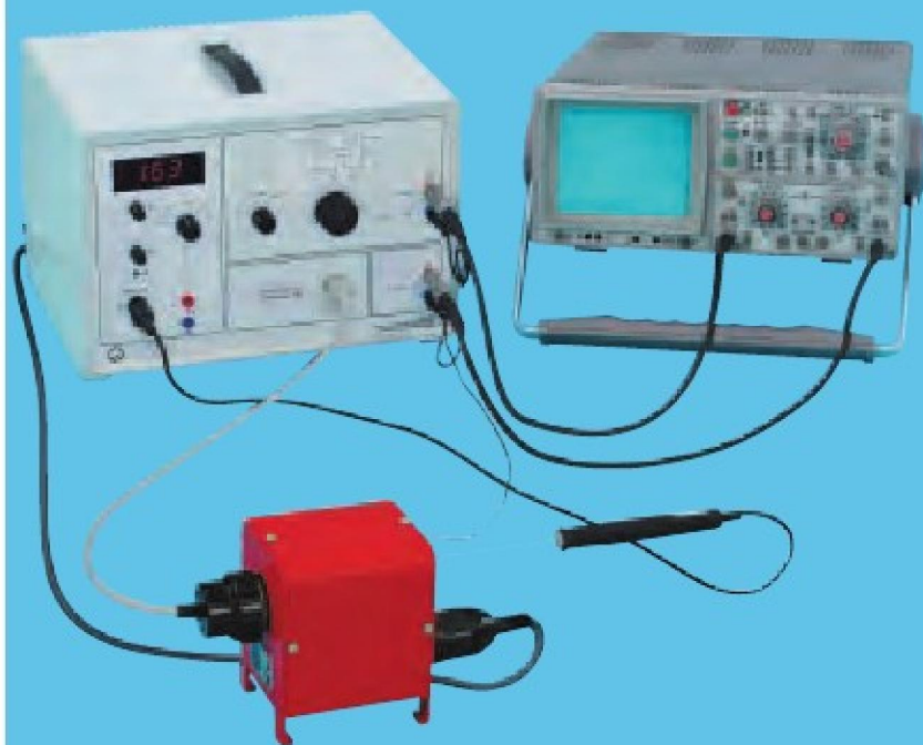
Doświadczenie Francka-Hertza z rtęcią. Rejestracja przy pomocy oscyloskopu (P6.2.4.1_b)
