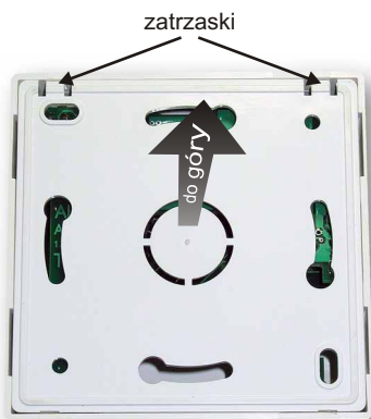
Rys.1. Demontaż ścianki tylnej
