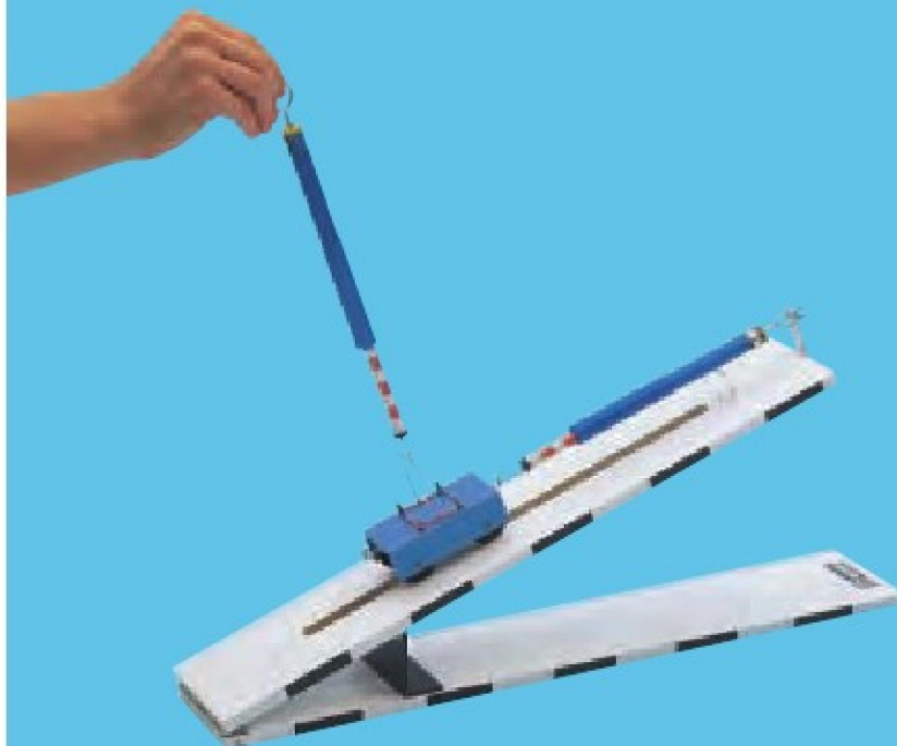
Równia pochyła: siły działające wzdłuż oraz prostopadle do płaszczyzny (P1.2.5.1)
