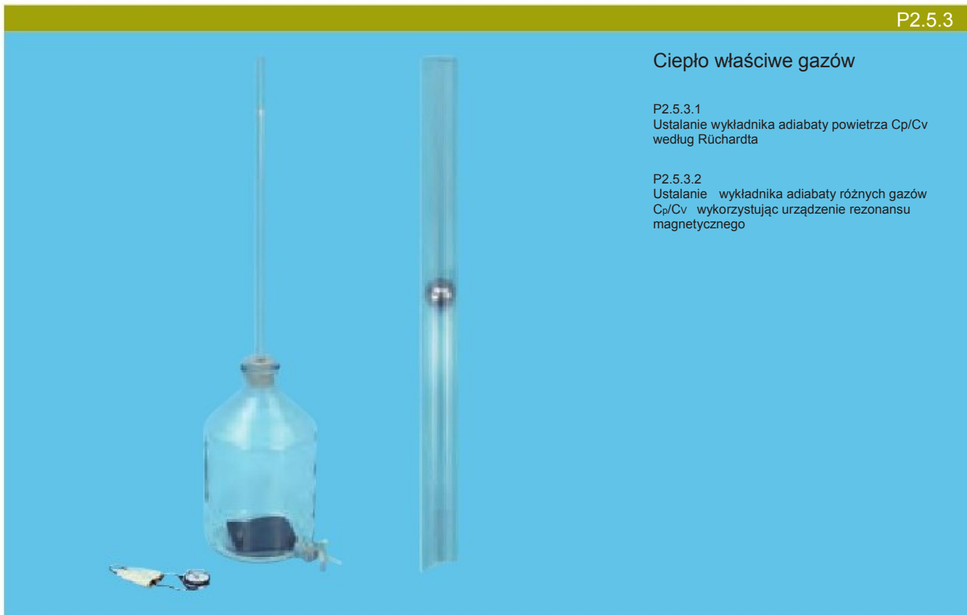
Ustalanie wykładnika adiabaty powietrza C_p/C_v według Rüchardta (2.5.3.1)
