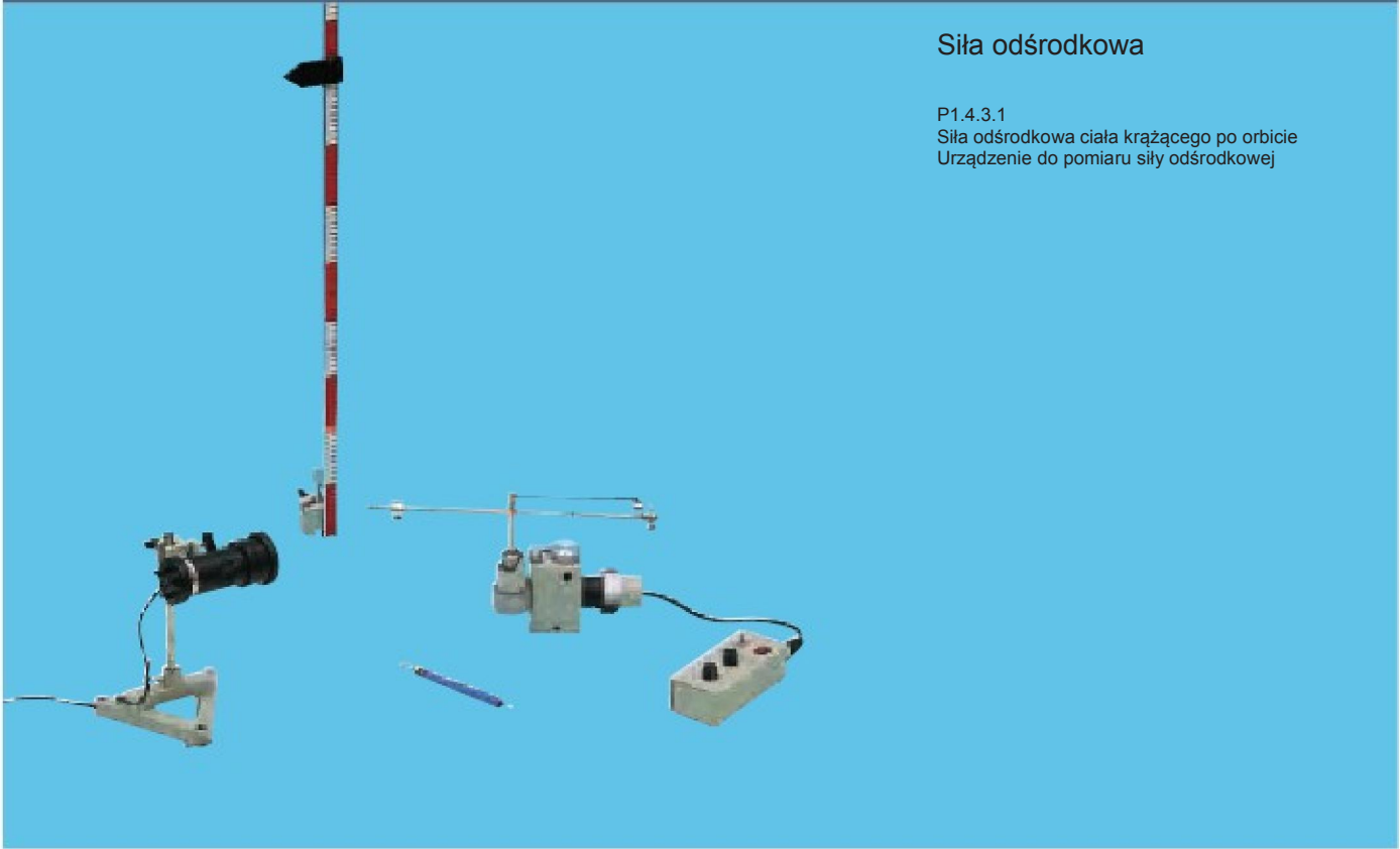
Siła odśrodkowa ciała krążącego po orbicie. Urządzenie do pomiaru siły odśrodkowej (P1.4.3.1)
