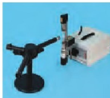
Obserwowanie serii widmowych wodoru przy użyciu spektrometru przyzmatowego (P6.2.1.2)
