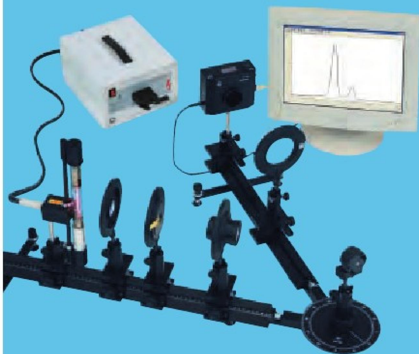
Obserwowanie podziału serii deuterowanego wodoru według Balmera (podział izotopu) (P6.2.1.3_b)
