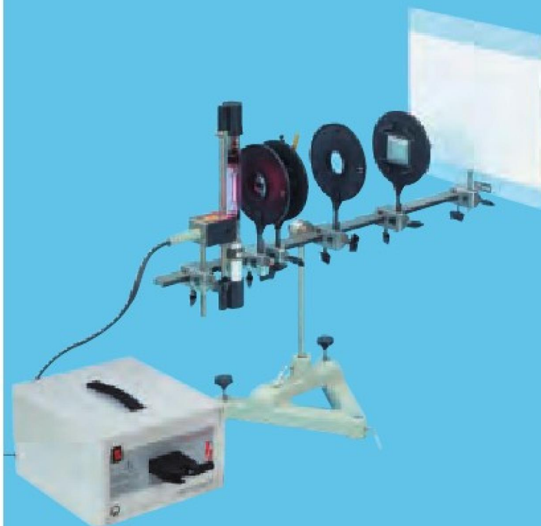
Określanie długości fali H_\alpha , H_\beta and H_\gamma na podstawie serii widmowych wodoru Balmera (P6.2.1.1)
