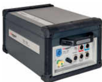
TDX120 - przystawka do pomiaru współczynnika tangens delta i pojemności
