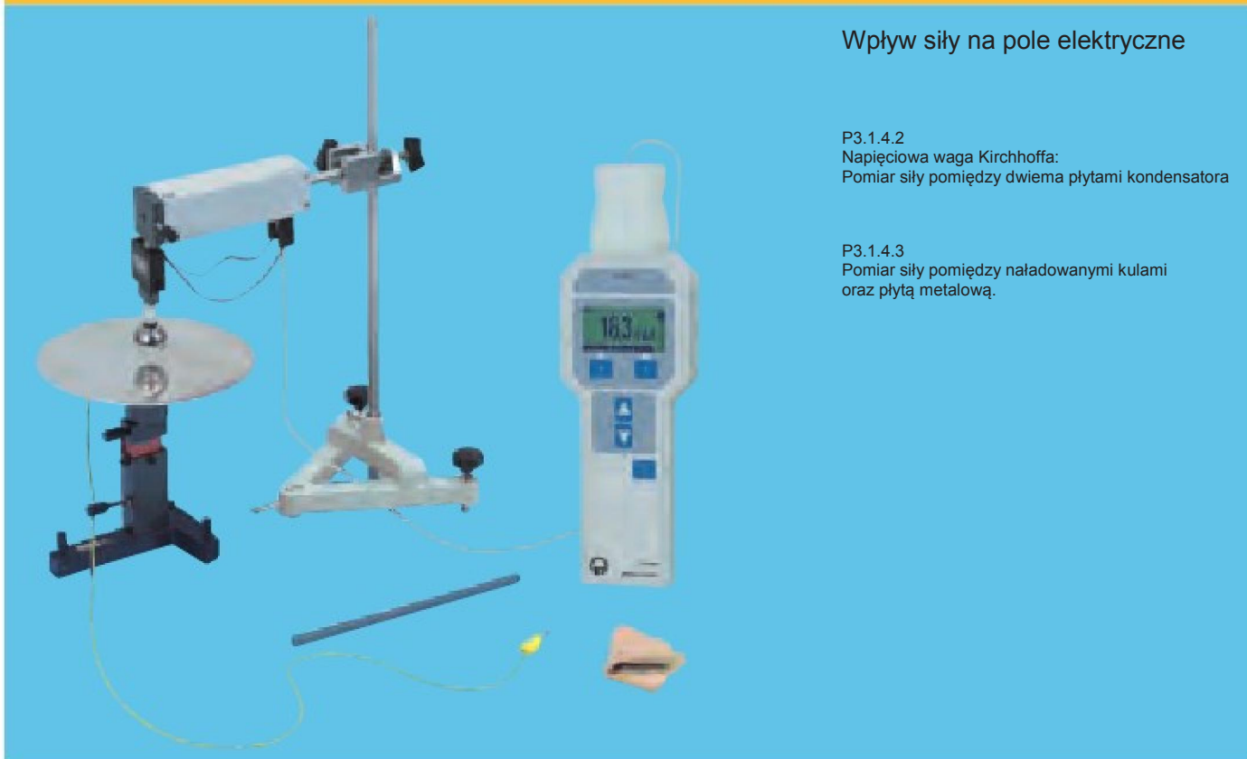
Pomiar siły pomiędzy naładowanymi kulami oraz płytą metalową. (P3.1.4.3_b)
