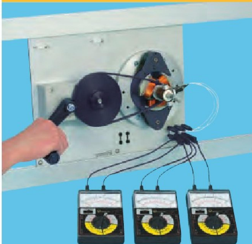
Doświadczenia z trójfazowym obrotowym twornikiem prądu (P3.5.4.1_b)
