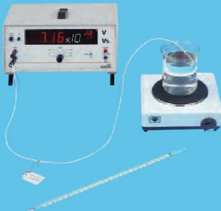
Zjawisko Seebecka: Określenie napięcia termoelektrycznego w funkcji różnej temperatury (P7.2.5.1_a)
