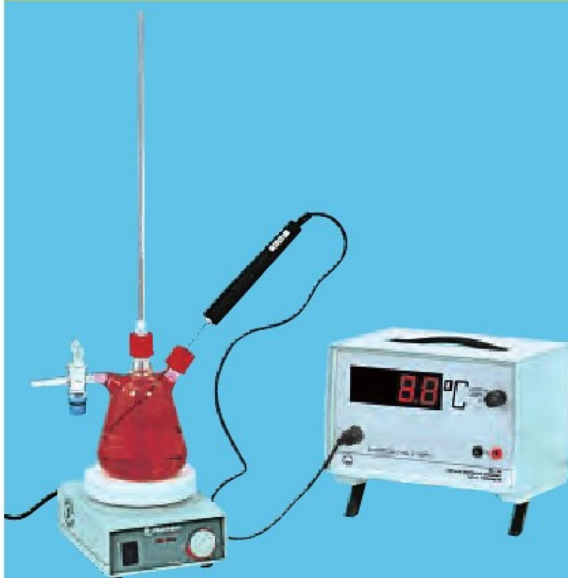
Badanie maksymalnej gęstości wody (P2.1.3.1_b)
