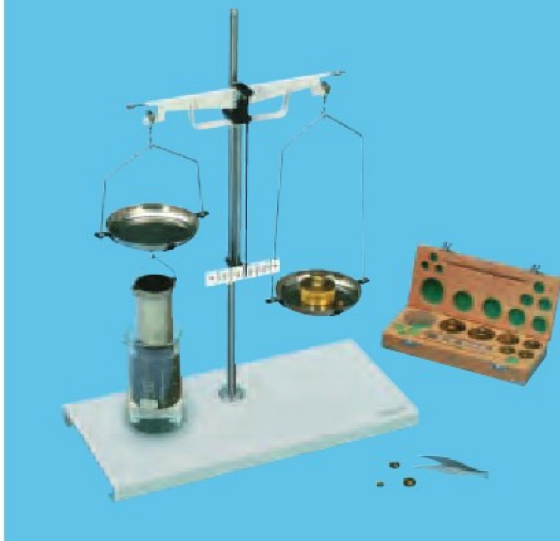
Potwierdzenie zasady Archimedeasa (P1.8.2.1)
