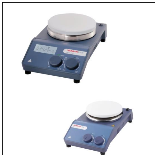
Mieszadło magnetyczne z grzaniem do 340 C Producent: Dragon
