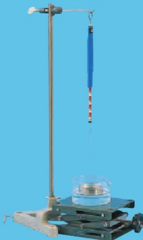
Pomiar napięcia powierzchniowego za pomocą metody „break-away” (P1.8.4.1)
