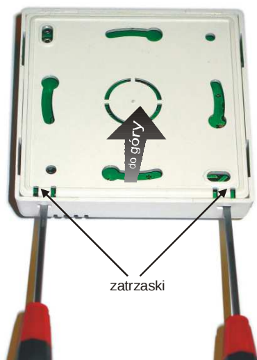
Rys.12.1. Demontaż ścianki tylnej
