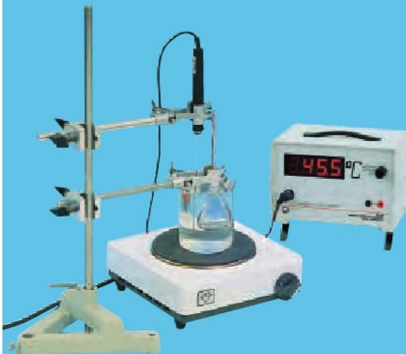
Określanie rozszerzenia objętościowego współczynnika cieczy (P2.1.2.1_b)
