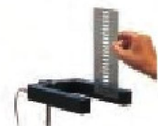
Swobodny spadek: wielokrotne pomiary za pomocą drabinki (P1.3.5.3)
