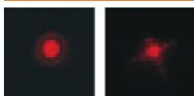
Optyczna analogia do dyfrakcji Debye'a-Scherrera (P6.1.5.2)
