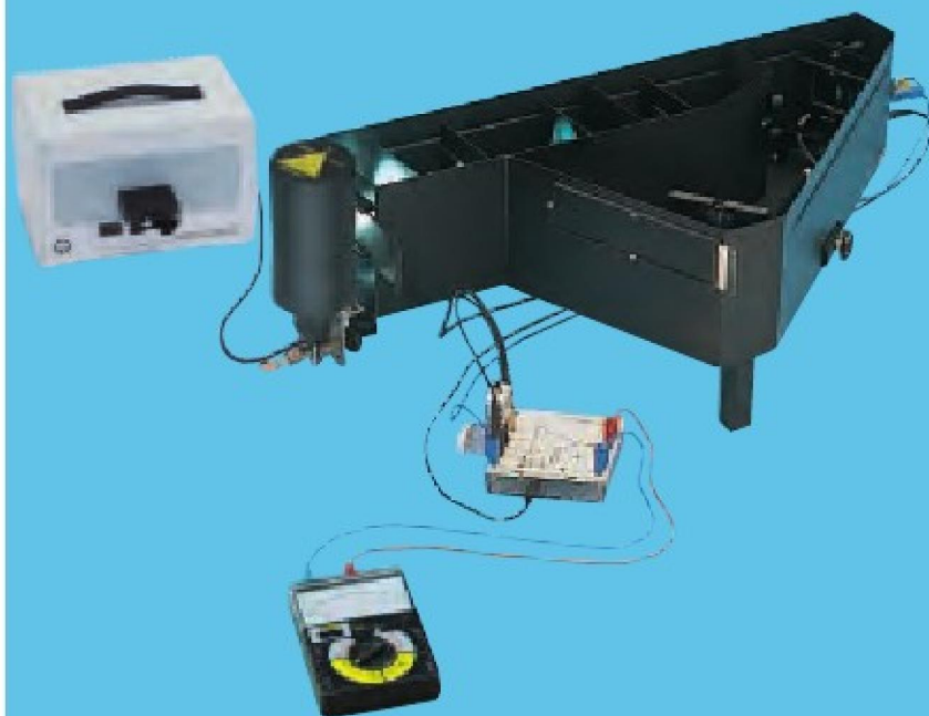
Określanie stałej Plancka. Pomiary na zestawie montażowym (P6.1.4.1)
