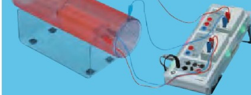
Pomiar napięcia w pętli przewodzenia dla zmiennego pola magnetycznego – zasilanego falą trójkątną. (P3.4.3.1)
