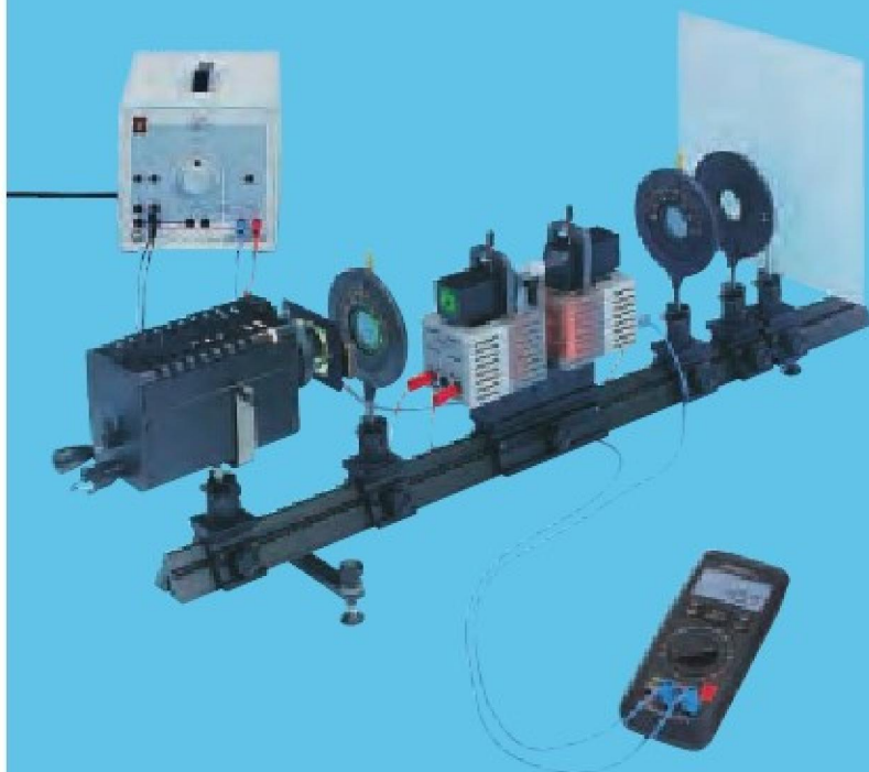
Efekt Faradaya: ustalanie stałej szkła krzemowego w funkcji długości fali (P5.4.6.1_b)
